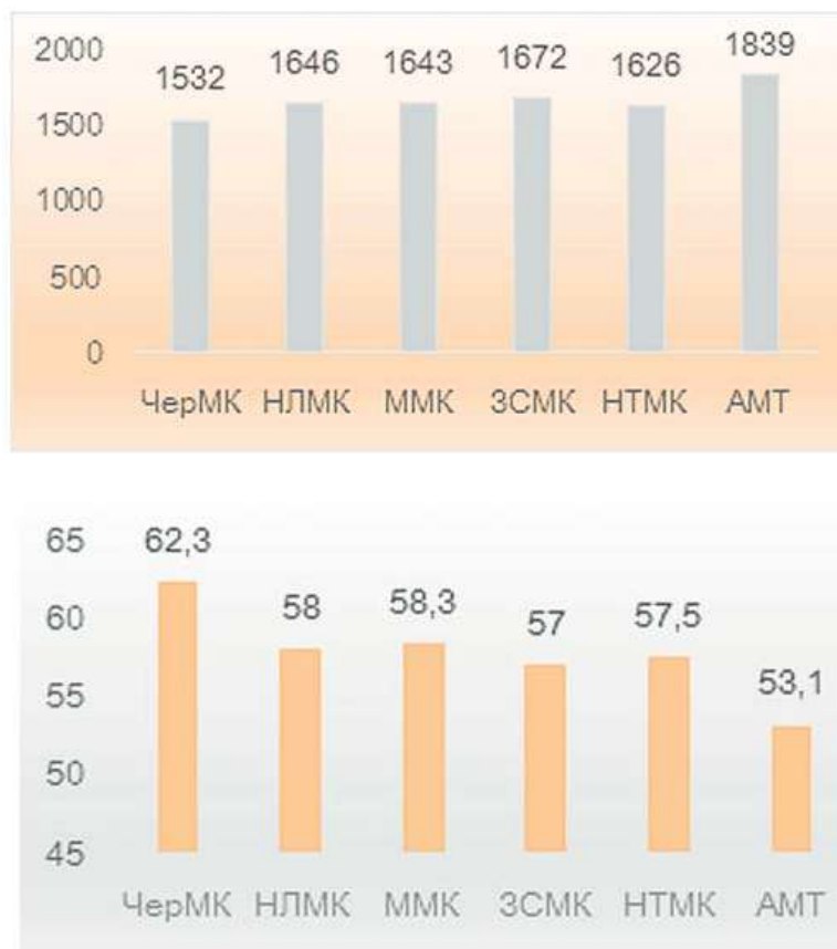
Рис. 2. Содержание железа в доменной шихте, % расход ЖРЧ в доменной шихте, кг/тонну
