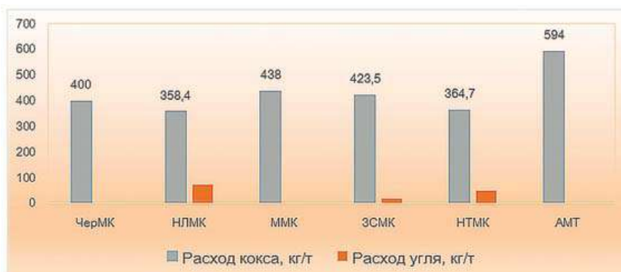
Рис. 3. Удельный расход кокса (угля) на производство чугуна, кг/т:
